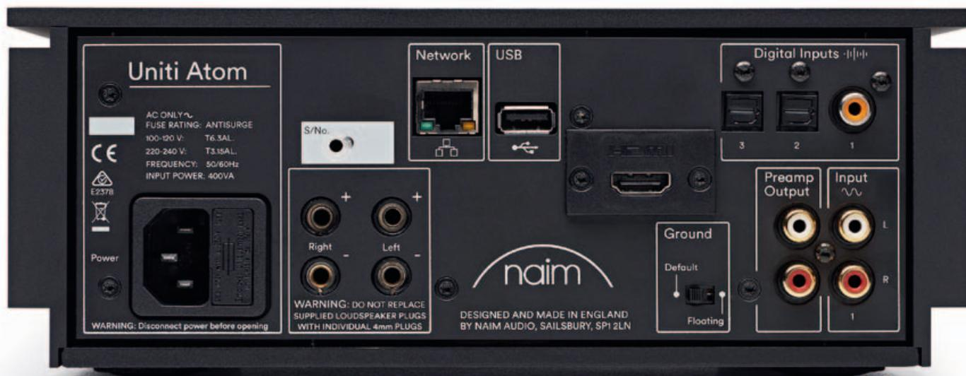
Nur einen Analog-Eingang besitzt der Uniti Atom. Sonst herrscht große Konnektivität. Neben LAN stellt er WLAN (802.11b/g/n/ac, 2,4 und 5 GHz) mit in die Kühlrippen integrierten Antennen, die nach innen abgeschirmt werden. Für Video-Fans gibt es sogar eine optionale HDMI-Buchse mit dem Audio-Rückkanal ARC. Die Class-A/B-Verstärkertechnik mit schnelleren Endtransistoren basiert auf den Nait-Verstärkern.
