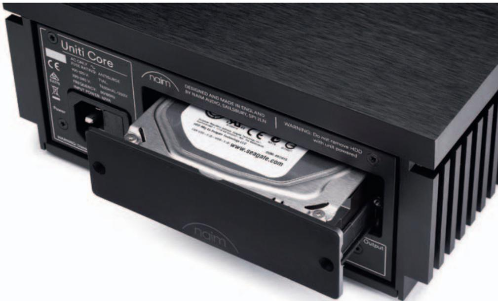
**Black the Ripper:** Durch den von hinten zugänglichen Montagerahmen ermöglicht der Uniti Core den schnellen Festplattentausch. Er eignet sich zur Verwendung mit SSD- und HDD-Platten, kann gerippte Songs aber auch übers Netzwerk auf einer NAS oder einer direkt verbundenen USB-Festplatte ablegen.
