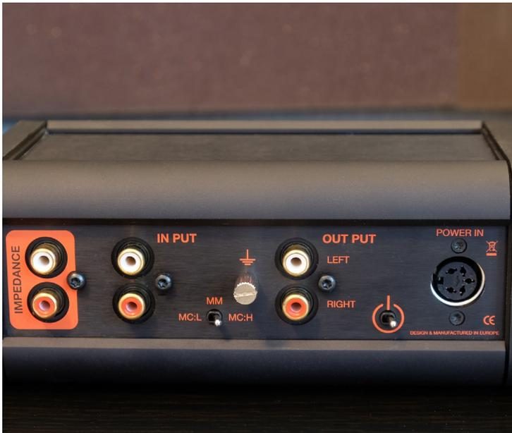
Über den kleinen Kippschalter (Mitte, unten) lässt sich die Profono optimal an MC- bzw. MM-Tonabnehmer anpassen.
